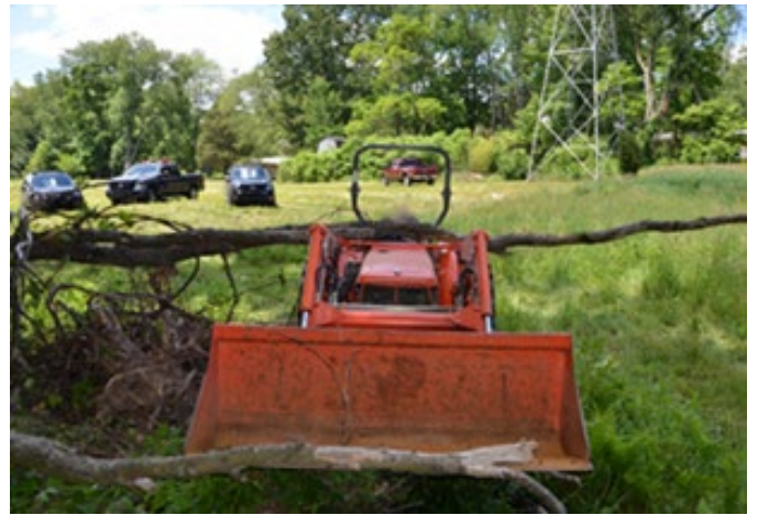
El asiento del tractor fue golpeado por un árbol que rodó hacia arriba y sobre el cubo
