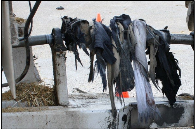
Un ejemplo de ropa envuelta alrededor de una toma de fuerza. De MIFACE Resumen de la Investigación MIOSHA #209
